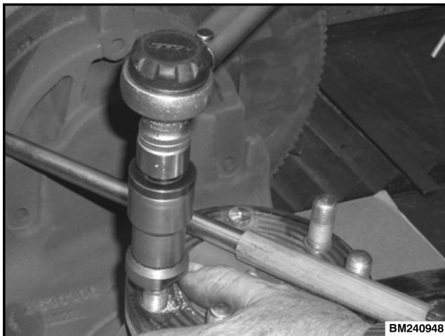
**Figure 13. Stud Installation**
