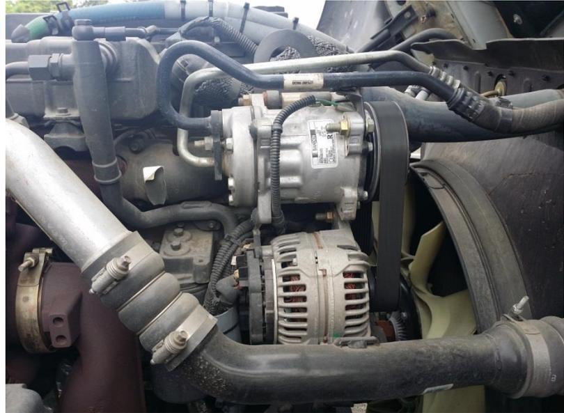
Sanden Compressor uses a 24 volt clutch
