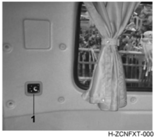
1. Контроллер отопления при ручном тормозе
