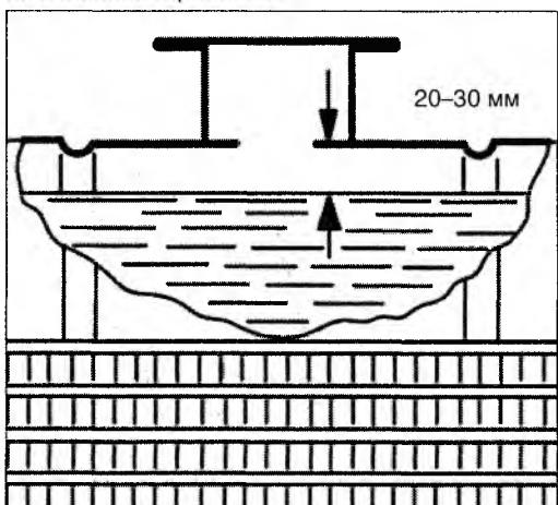
**ВНИМАНИЕ!** Перед доливкой охлаждающей жидкости осмотрите радиатор и двигатель на наличие утечек, при обнаружении устранит причину их возникновения.
