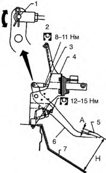
1. шплинт крепления осевого пальца; 2. контргайка;
