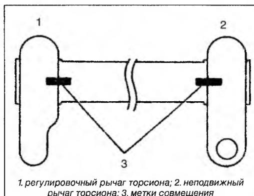
1. регулировочный рычаг торсиона; 2. неподвижный рычаг торсиона; 3. метки совмещения
