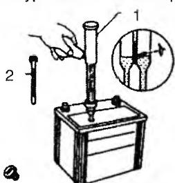
1. ареометр; 2. термометр
