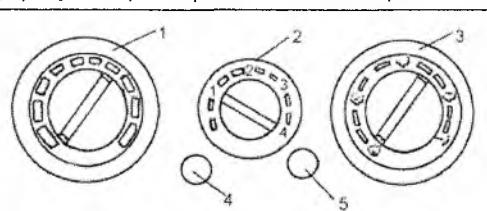
1. переключатель (резервный); 2. переключатель вентилятора; 3. переключатель выбора направления потока воздуха; 4. заплата; 5. выключатель режима рециркуляции
