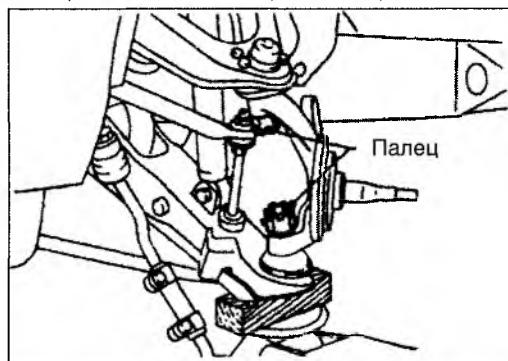
**ВНИМАНИЕ!** Перед установкой конические поверхности пальцев шаровых опор и отверстий в поворотном кулаке должны быть чистыми и сухими. Никогда не смазывайте их. При сборке следите за тем, чтобы не повредить пыльник шаровой опоры.
