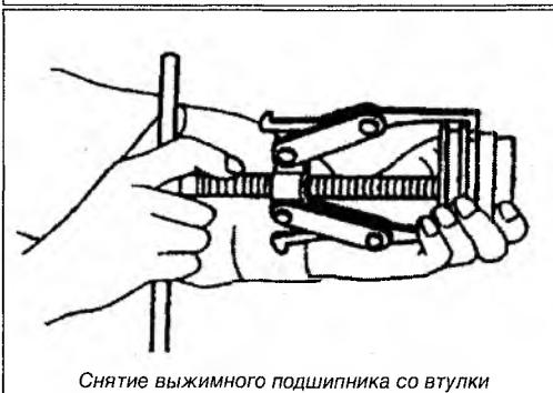
Снятие выжимного подшипника со втулки
