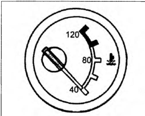
**ВНИМАНИЕ!** Если температура превысила предельно допустимое значение, необходимо срочно прекратить движение. Работа двигателя при повышенных температурах крайне опасна и вредна для него.
