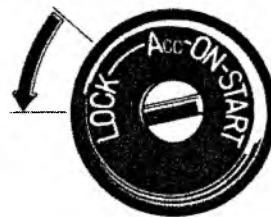
START – в этом положении работает стартер. После того, как двигатель начнет работать, а ключ зажигания будет отпущен, ключ автоматически вернется в положение ON.
