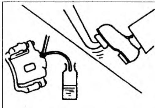
**ВНИМАНИЕ!** Для долива и заправки системы используйте только жидкость с действующим сроком годности из свежеоткрытой тары. Пролитую на окрашенные кузовные поверхности тормозную жидкость незамедлительно смойте холодной водой – жидкость весьма агрессивна.
