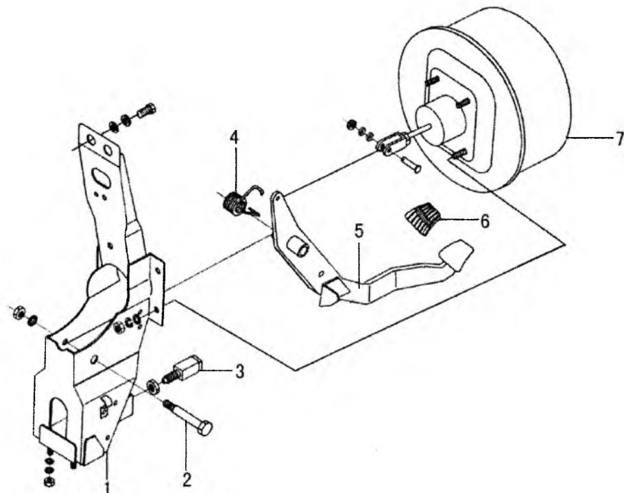
1. кронштейн; 2. осевой палец; 3. выключатель стоп-сигналов; 4. возвратная пружина; 5. тормозная педаль;
