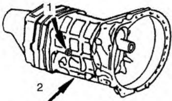
1. заливная пробка; 2. сливная пробка
