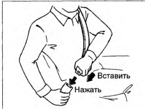
**ВНИМАНИЕ!** Отрегулируйте положение сиденья. Убедитесь в том, что ремень нигде не перекручен и не передавлен. Не допускается воздействие на ремень кислоты или других химически агрессивных веществ. Один ремень предназначен только для одного человека. Если ремень износился, порвался или был поврежден другим способом, его необходимо заменить полностью. Если фиксирующая катушка ремня не работает, необходимо незамедлительно заменить весь ремень.
