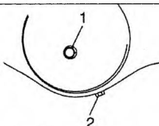
1. пробка отверстия контроля уровня; 2. сливная пробка
