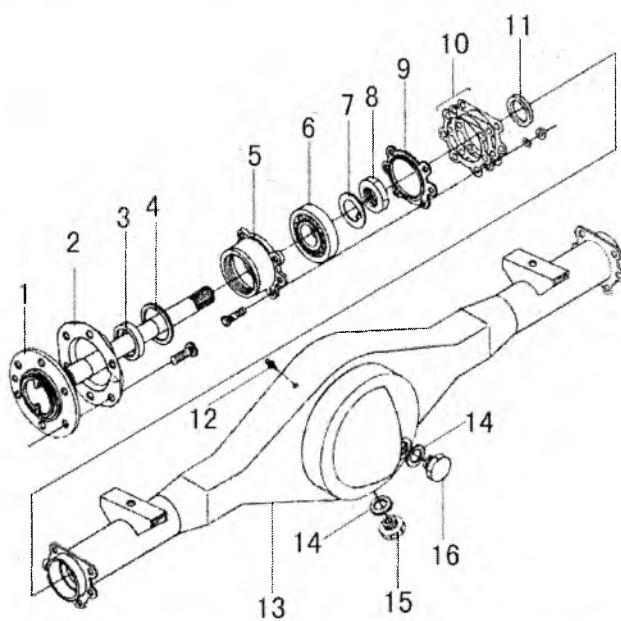
1. полуось заднего моста; 2. пыльник; 3. дистанционное кольцо; 4. наружный сальник полуоси; 5. корпус подшипника полуоси; 6. опорный подшипник полуоси; 7. запорное кольцо; 8. гайка крепления подшипника полуоси; 9. прокладка; 10. дистанционные (регулировочные) прокладки; 11. внутренний сальник полуоси; 12. сапун; 13. картер редуктора заднего моста; 14. уплотнительная шайба; 15. сливная пробка; 16. заливная/контрольная пробка
