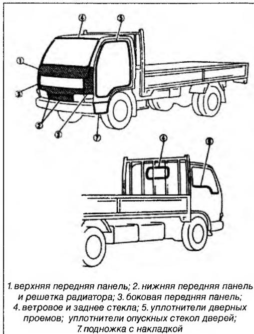
1. верхняя передняя панель; 2. нижняя передняя панель и решетка радиатора; 3. боковая передняя панель; 4. ветровое и заднее стекла; 5. уплотнители дверных проемов; 6. уплотнители опускных стекол дверей; 7. подножка с накладкой
