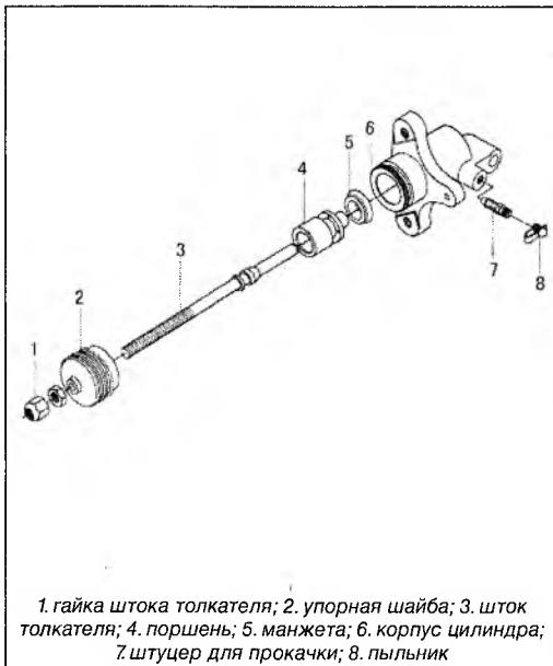
1. гайка штока толкателя; 2. упорная шайба; 3. шток толкателя; 4. поршень; 5. манжета; 6. корпус цилиндра; 7. штуцер для прокачки; 8. пыльник
