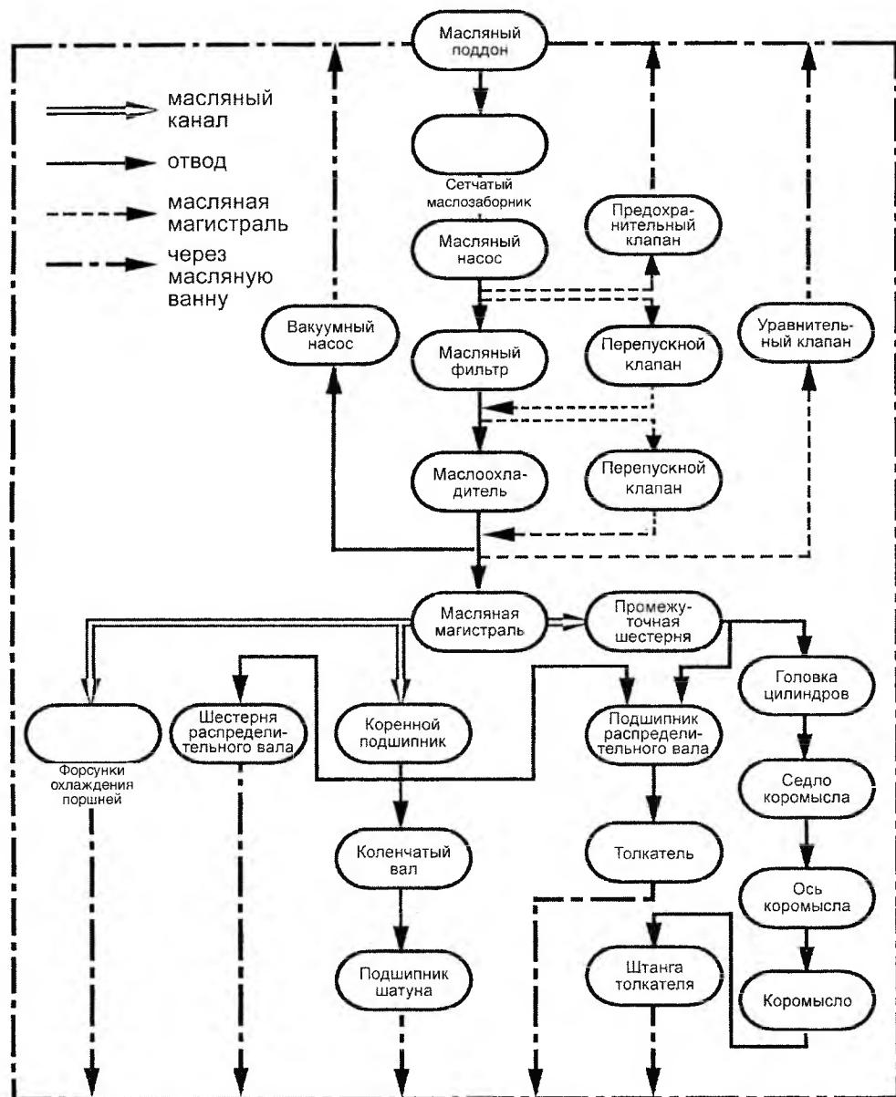
Схема системы смазки
