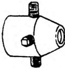
Оправка для снятия/установки ступичных подшипников
