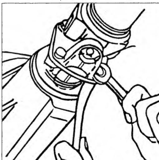
**ВНИМАНИЕ!** Перед началом любых ремонтных работ, связанных с рассоединением частей карданного вала, нанесите на деталях сопряженные метки. Обратную сборку выполнайте с совмещением данных меток. Несовмещение меток нарушает балансировку карданного вала в сборе и может привести к его разрушению в процессе эксплуатации.
