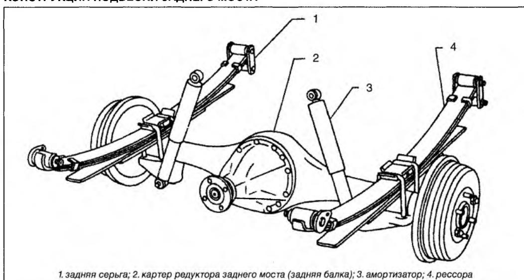
1. задняя серьга; 2. картер редуктора заднего моста (задняя балка); 3. амортизатор; 4. рессора
