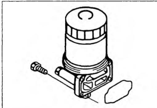
**ВНИМАНИЕ!** Не затягивайте фильтр ключом-съемником, так как это может повредить фильтр и деформировать резьбу. Учтите, что тип фильтра должен в точности соответствовать указанному производителем для данного автомобиля.
