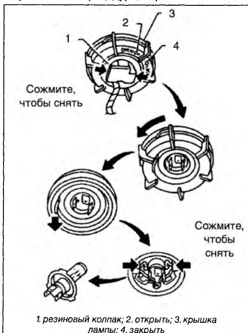
**ВНИМАНИЕ!** Сняв лампу, не оставляйте отражатель открытым надолго. Пыль, масляные пары и прочая грязь приведут к его потускнению и быстрому выходу из строя фары. Снимайте лампу только для замены.
