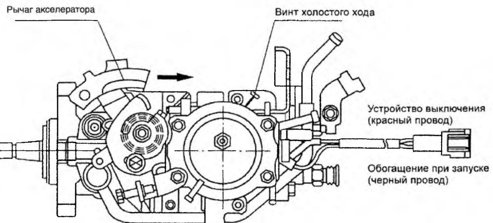
Механизм управления насосом VE у дизельного двигателя CYQD32
