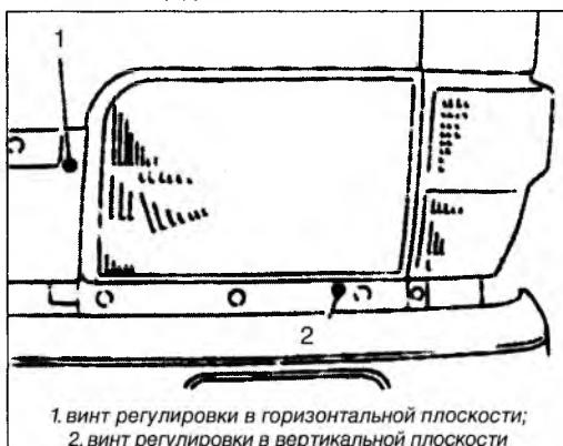
1. винт регулировки в горизонтальной плоскости;
