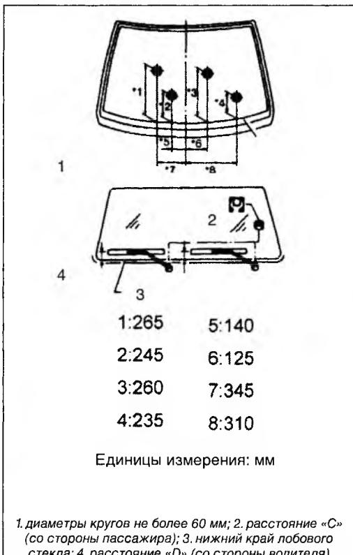
1. диаметры кругов не более 60 мм; 2. расстояние «С» (со стороны пассажира); 3. нижний край лобового стекла; 4. расстояние «D» (со стороны водителя)
