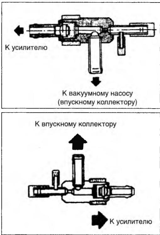
Клапан должен пропускать воздух от усилителя к впускному коллектору; в обратном направлении клапан должен быть закрыт.
