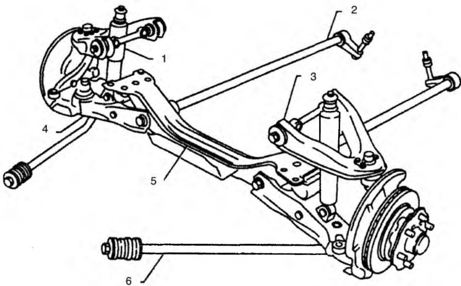
1. амортизатор; 2. торсион; 3. верхний поперечный рычаг; 4. нижний поперечный рычаг; 5. поперечная балка (поперечина передней подвески); 6. растяжка рычага подвески
