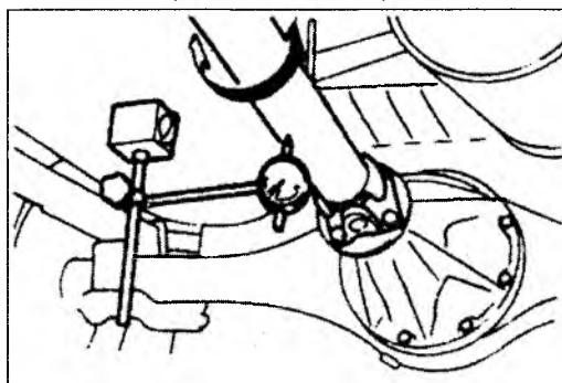
Точки на карданном валу для проведения измерений: A = 155 мм, B = 165 мм, C = 185 мм.
