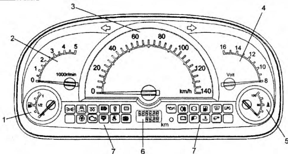
1. указатель уровня топлива; 2. такометр; 3. спидометр;
