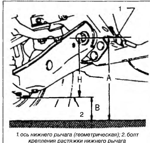
1. ось нижнего рычага (геометрическая); 2. болт крепления растяжки нижнего рычага
