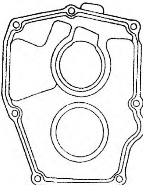
Нанесение герметика на заднюю крышку
