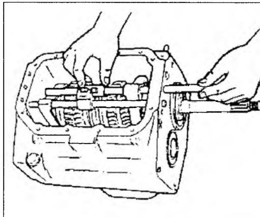
Установите в гнезда корпуса два стальных шарика между штоком вилки включения третьей/четвертой передач и штоком вилки включения пятой передачи/заднего хода.
