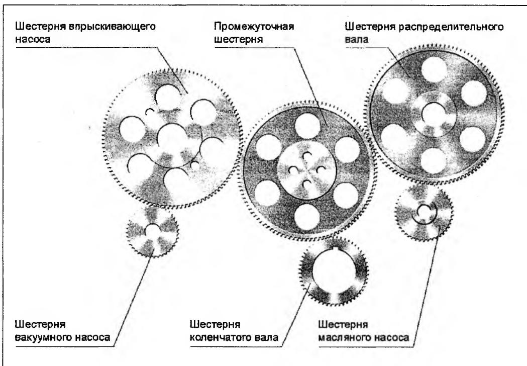
При сборке шестерен необходимо правильно совместить установочные метки на поверхности шестерен для обеспечения правильной подачи в камеры сгорания воздуха и топлива.
