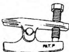
Съемник для снятия рулевых наконечников
