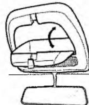
При нажатии на левый выключатель подсветки оба фонаря загорятся вне зависимости от того, открыты двери автомобиля или нет. Работа подсветки при нажатой правой кнопке выключателя в салоне будет означать, что одна из дверей автомобиля не закрыта.
