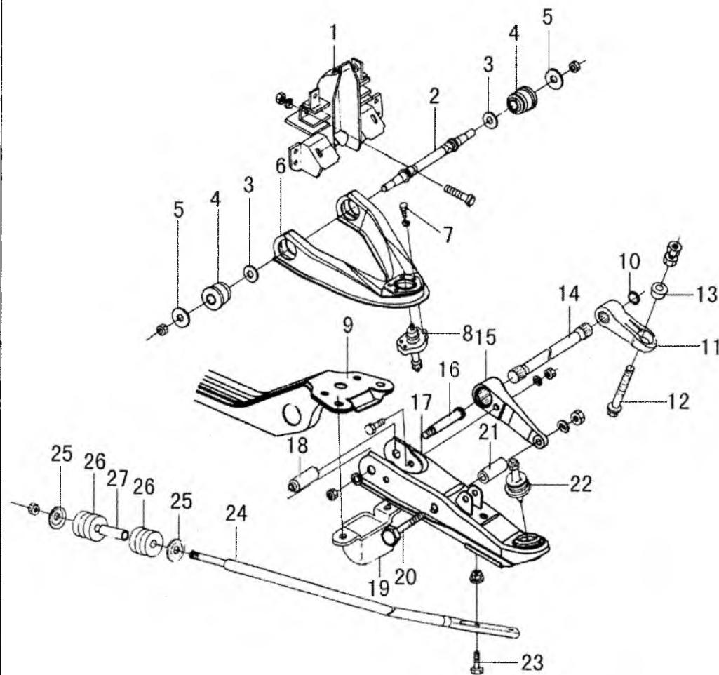
1. кронштейн; 2. ось верхнего рычага; 3. внутренняя шайба; 4. резинометаллическая втулка (сайлент-блок);
