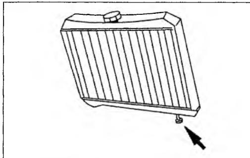
• при заливке охлаждающей жидкости сначала влейте ее в радиатор, а затем в расширительный бачок до отметки максимального уровня.
