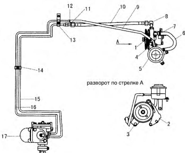
1. насос ГУР; 2. кронштейн насоса; 3. болт; 4. болт; 5. бачок гидравлической жидкости; 6. питающая трубка (низкого давления) насоса; 7. хомут; 8. регулируемый угловой штуцер; 9. возвратный шланг (низкого давления); 10. питающий шланг (высокого давления); 11. прямое штуцерное соединение; 12. хомут; 13. верхний кронштейн крепления гидравлических трубок; 14. нижний кронштейн крепления трубок; 15. питающая трубка; 16. возвратная трубка; 17. рулевой механизм
