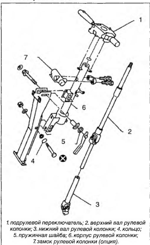
1. подрулевой переключатель; 2. верхний вал рулевой колонки; 3. нижний вал рулевой колонки; 4. кольцо; 5. пружинная шайба; 6. корпус рулевой колонки; 7. замок рулевой колонки (опция).
