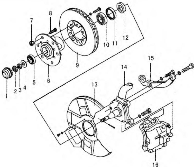
1. защитный колпак ступичного подшипника; 2. стопорное кольцо; 3. ступичная гайка; 4. упорная шайба;
