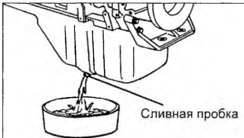
• заверните пробку и затяните ее моментом затяжки 75–95 Нм;
