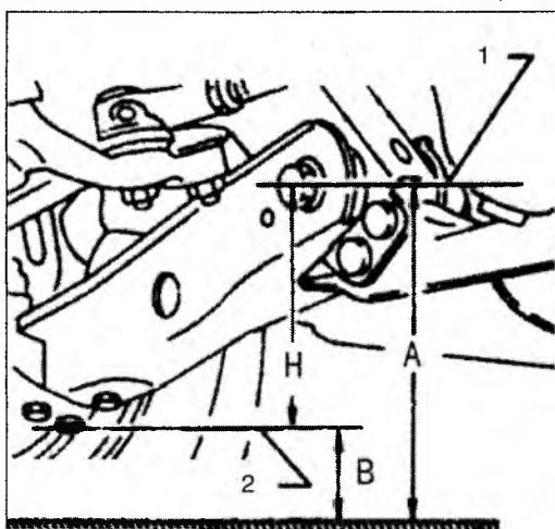
1. центр нижнего рычага; 2. болт крепления растяжки нижнего рычага
