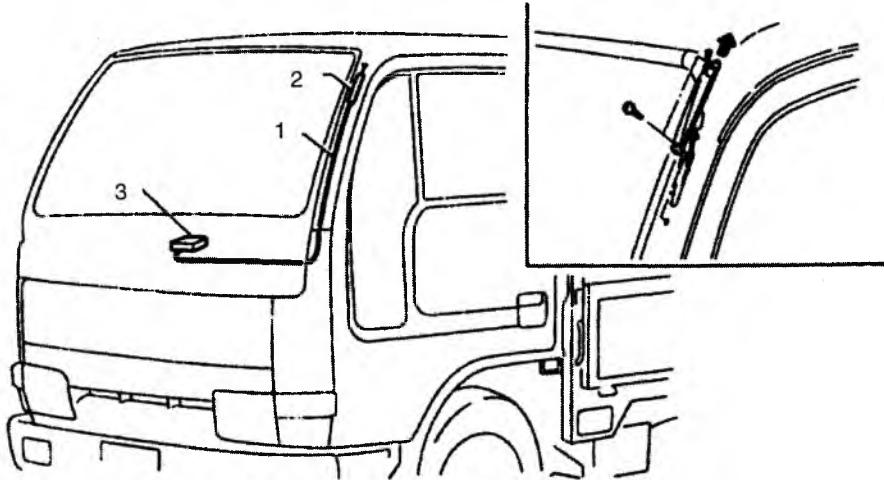
1. кабель антенны; 2. антenna; 3. радиоприемник
