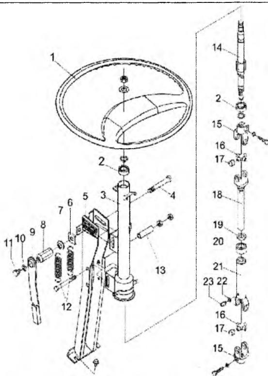
1. рулевое колесо; 2. втулка; 3. труба вала рулевого колеса; 4. болт регулировки положения рулевого колеса; 5. кронштейн регулировки положения рулевого колеса; 6. шайба; 7. шайба; 8. втулка; 9. рычаг регулировки положения рулевого колеса; 10. втулка; 11. болт; 12. пружины; 13. втулка; 14. вал рулевого управления; 15. вилка карданныго шарнира; 16. крестовина; 17. подшипник; 18. вал рулевого управления; 19. втулка; 20. втулка; 21. вал рулевого управления; 22. прокладка; 23. винт
