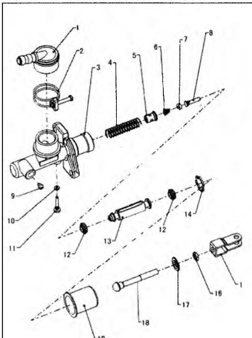
1. входной штуцер; 2. проволочный хомут; 3. корпус главного цилиндра; 4. возвратная пружина; 5. седло; 6. пружина; 7. манжета; 8. толкатель клапана; 9. штуцер; 10. уплотнительная втулка; 11. ограничительный винт; 12. манжета; 13. поршень; 14. стопорное кольцо; 15. резьбовая вилка толкателя; 16. контргайка; 17. дистанционная шайба толкателя; 18. шток толкателя; 19. пыльник
