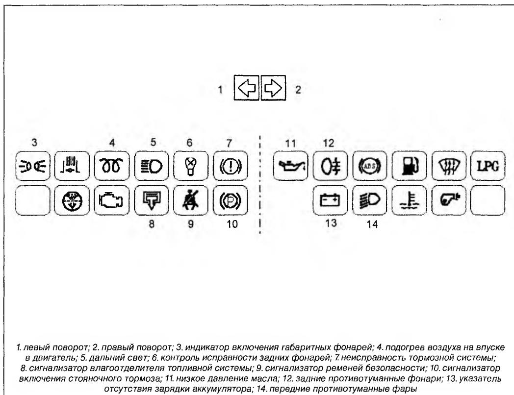
1. левый поворот; 2. правый поворот; 3. индикатор включения габаритных фонарей; 4. подогрев воздуха на впуске в двигатель; 5. дальний свет; 6. контроль исправности задних фонарей; 7. неисправность тормозной системы;
