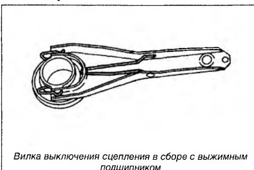
Вилка выключения сцепления в сборе с выжимным подшипником
