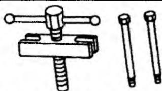
Съемник для снятия рулевого колеса
