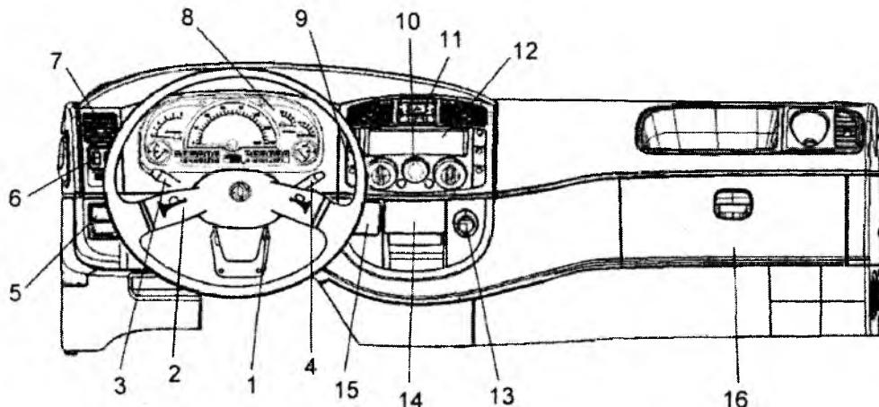
1. замок зажигания; 2. кнопка звукового сигнала; 3. комбинированный переключатель; 4. переключатель очистителя и омывателя ветрового стекла; 5. выключатель света в салоне; 6. кнопка управления стеклоподъемниками; 7. дефлекторы системы вентиляции; 8. панель приборов; 9. выключатель противотуманных фар; 10. переключатель отопителя; 11. выключатель аварийной сигнализации; 12. магнитола; 13. прикуриватель; 14. пепельница; 15. вещевой контейнер; 16. вещевой ящик
