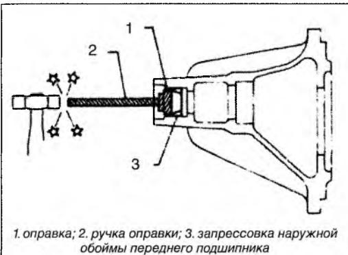
1. оправка; 2. ручка оправки; 3. запрессовка наружной обоймы переднего подшипника
