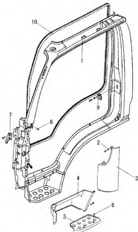
1. сварная рама двери; 2. пластиковая гайка; 3. наружная накладка; 4. панель подножки; 5. накладка подножки; 6. крепление подножки; 7. кронштейн дверной петли; 8. резиновая втулка; 9. защелка замка; 10. уплотнитель дверного проема
