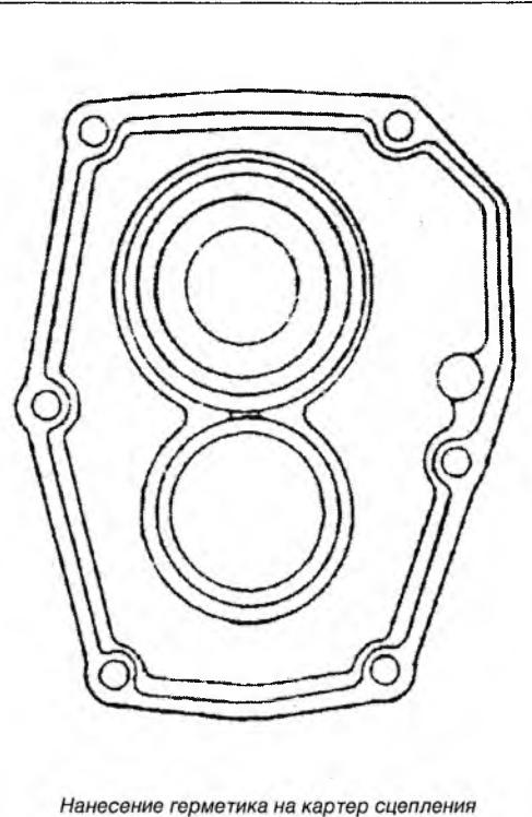
Нанесение герметика на картер сцепления
