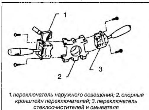
Чтобы снять подрулевой переключатель, отверните болты его крепления к опорному кронштейну.
