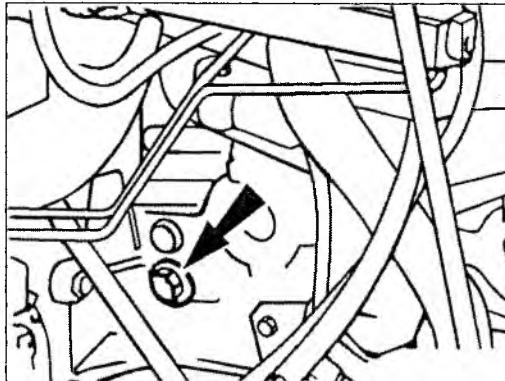
**ВНИМАНИЕ!** Слив охлаждающей жидкости нужно проводить только на холодном двигателе.
