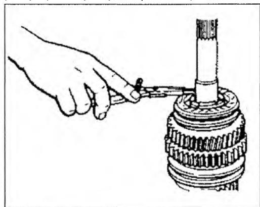
**ВНИМАНИЕ!** Поскольку стопорные кольца подобраны по толщине, в соответствии с рабочими зазорами узла синхронизатора, при обратной сборке не перепутайте снятые кольца местами.
