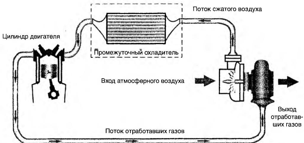
Иллюстрация принципа действия турбонагнетателя
