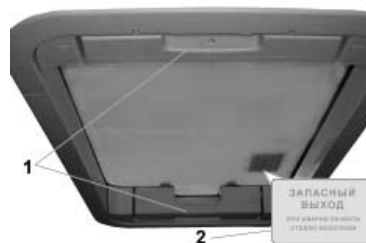
Рис. 3.30. Люк крыши: 1 -ручки; 2 -инструкционная табличка
