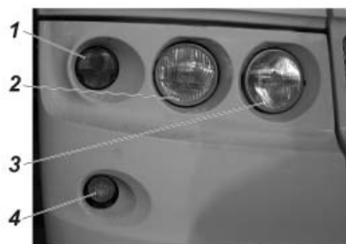
Рис. 5.20. Передние фонари: 1 - передний габаритный фонарь и указатель поворота; 2 - фара ближнего и дальнего света; 3 - фара дальнего света; 4 - противотуманная фара
