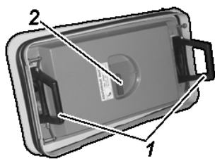
Рис. 3.29. Люк крыши: 1 -ручки; 2 -аварийная ручка
