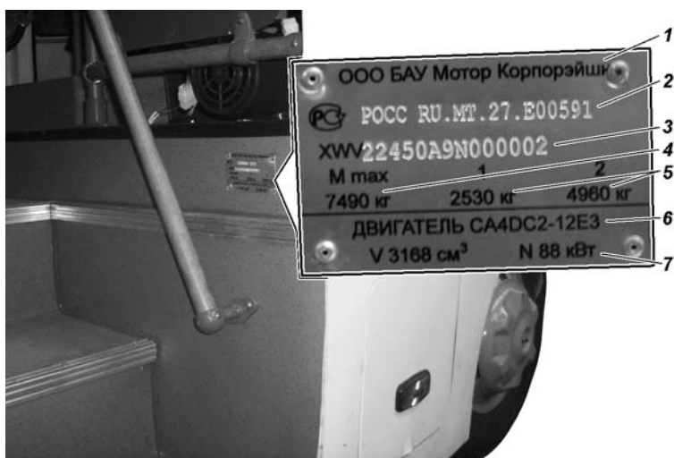
Рис. 1.6. Табличка заводских данных: 1 -товарный знак и наименование предприятия изготовителя; 2 -знак соответствия и номер "Одобрения типа транспортного средства"; 3 -код VIN; 4 -максимально допустимая масса транспортного средства; 5 - максимально допустимые нагрузки по осям; 6 -тип двигателя; 7 -дополнительная информация
