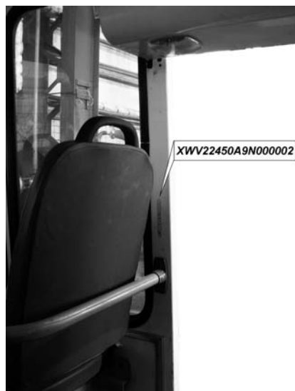
Рис. 1.5. Расположение идентификационного номера автобуса
