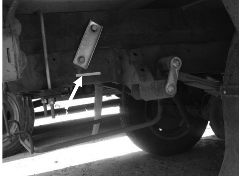
Рис. 1.6.5 Идентификационный номер шасси
