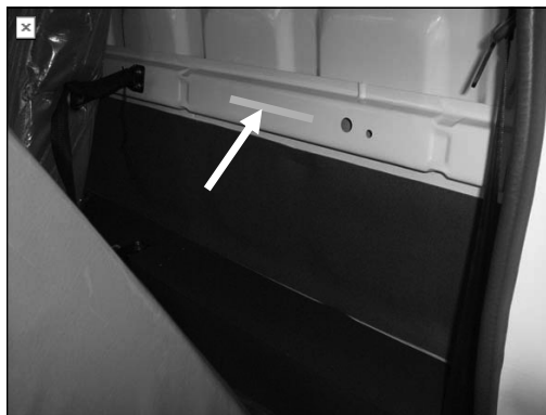
Рис.1.6.4 Идентификационный номер кабины
